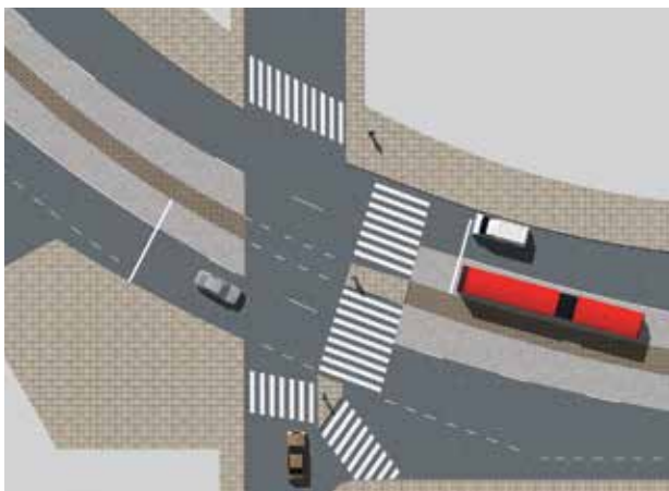
图 4.2.2 | 人行横道设计前后对比，设计创建了直线和更短路线
