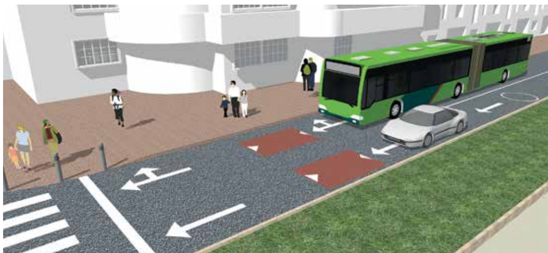
分段式减速带可让轴距较宽的车辆通过，从而提高公交乘客的舒适度。
